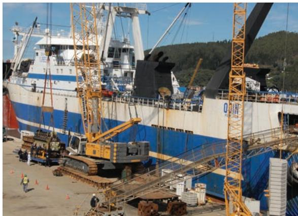
de cubierta, motor eléctrico de compresor de amoniaco, reparación del tambor de red del winche arrastre de babor y recorrida de su motor hidráulico, reparación de portalones de pesca y equipos mecánicos varios de cubierta.
