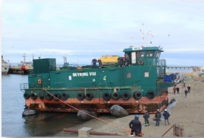
Por primera vez, se realizó una maniobra de varada de un pontón, a través del sistema de globos inflables (air roller-bags) maniobra que otorga una mayor flexibilidad y disponibilidad en la programación, al contar con dos entradas de buques al Astillero. Su alcance es para pontones o barcasas de hasta 700 toneladas.
